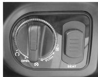
点火开关有4个位置和1个按钮。解锁点火开关后，才能转动点火开关。
