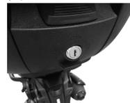
4. 把钥匙转动到“LOCK (锁)”位置, 将尾箱固定在后货架上。
