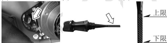
按照下列步骤检查发动机机油的油位。
