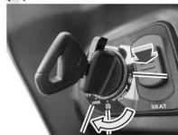
1. 使用回形针等金属针状工具插入点火开关的小孔中。
