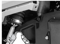
4. 从进气管(波纹管)⑦口部吹入压缩空气, 将进气管中的灰尘吹出。
