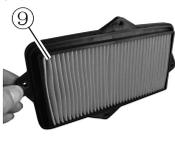
5. 拆下螺钉⑧，拆下纸滤芯⑨和海绵滤芯⑩。海绵滤芯⑩检查、清理或更换。纸滤芯⑨不用清理，检查、更换纸滤芯即可。
