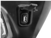
在前货箱上面, 配有一个电源接口。打开防护胶盖就可以看到。发动机运转时, 电源接口可以提供最大为18瓦(18W)的电源输出。使用电器附件前, 检查额定功率是否符合要求。
