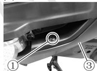
1. 拆下螺钉①, 拆下膨胀扣②, 拆下左边条③。
