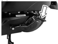
本摩托车装有脚起动杆，位于发动机的左边。要起动发动机时，需用主停车架平稳地支起摩托车后，再用力踩下脚起动杆。
