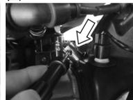
3. 断开束带③与燃油箱盖④的连接。
