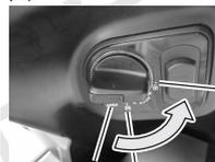
为了锁定转向机构，解锁点火开关后，先将车把转向极左位置，在“O”位置或“OPEN”位置将点火开关按到底，逆时针方向转到“L”位置。
