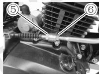
检查离合器拉索间隙④的方法是：沿拉索移开胶套①，操纵离合器手柄，在有明显的阻力之前，应有3~5毫米的间隙。如果发现间隙不对，可按如下方法调整。
