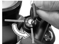
为了锁定转向机构，先将车把转向极左位置，在“⊗”位置将钥匙按到底，逆时针方向转到“🔒”位置。此时钥匙可以拔出。点火电路切断。
