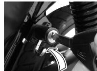
插入钥匙，顺时针旋转把头盔锁的钩扣打开，再将头盔上的扣环套进钩扣，逆时针旋转钥匙，锁上头盔锁后拔下钥匙。
