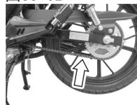
传动链条的调整(图34-01, 图34-02, 图34-03, 图34-04)
