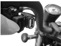
在左手把开关旁边, 本车配有一个额定电压为5伏(5V)的电源接口, 接口上盖有防护胶盖。当发动机运转时, 该接口可以提供最大功率为10瓦(10W)的电源输出。使用该电源接口时, 应先检查使用电器的额定电压及最大功率是否符合额定电压为5伏、最大功率为10瓦的要求。
