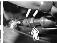
后制动开关位于车架右侧下部，适当调整后制动开关螺母，在踩下后制动踏板稍感压力时制动灯点亮。
